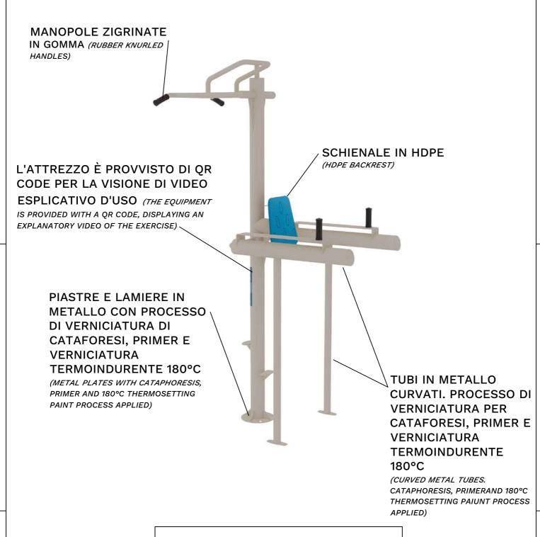
TUTTI GLI ELEMENTI DI FISSAGGIO, VITI, DADI, RONDELLE ECC. SONO IN ACCIAIO INOX
